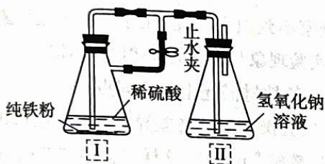
图2 制备氢氧化亚铁的实验装置图
