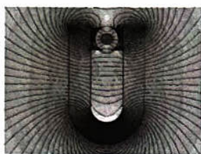
图 5 Femm 软件绘制的磁感线
